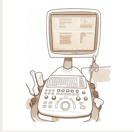
الٹراساؤنڈ مشین: ہاتھ میں پکڑا جانے والا پروب آواز کی لہریں بھیجتا اور ان کی کوچ سناتا ہے، اور اسکرین پر اسی لمحے تصویر بناتا ہے۔ Erereony / Wikimedia Commons, CC BY 4.0
